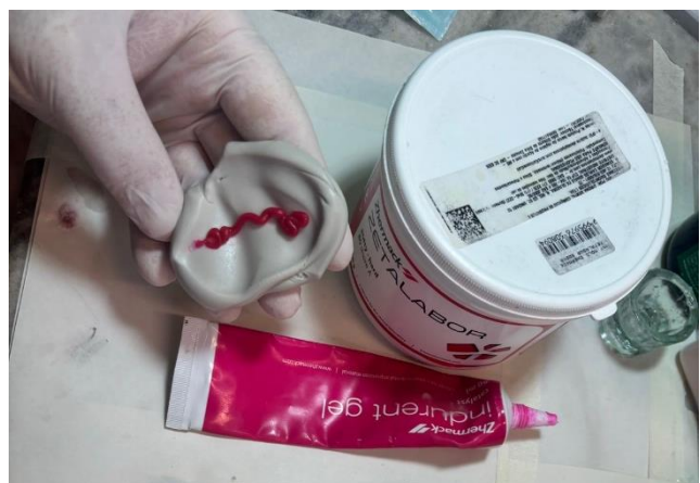
Figura 3: Manipulação/preparo do silicone por condensação laboratorial (Silicone para Laboratório Zetalabor 900g – Zhermack), de acordo com as recomendações do fabricante (Fonte: Autores).
