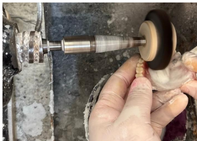
Figura 27: Polimento utilizando mistura cremosa de pedrapomes/água e escova de cerdas montada em torno protético (Fonte: Autores).
