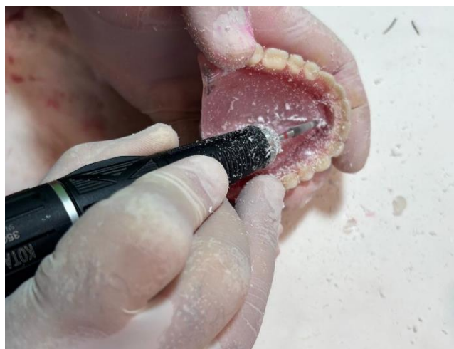
Figura 15: Abertura de canaleta, com cerca de 1 a 1,5 mm de profundidade, em ângulo de cerca de 45 graus, perpendicular à linha de fratura, na face palatina/externa da prótese (Fonte: Autores).
