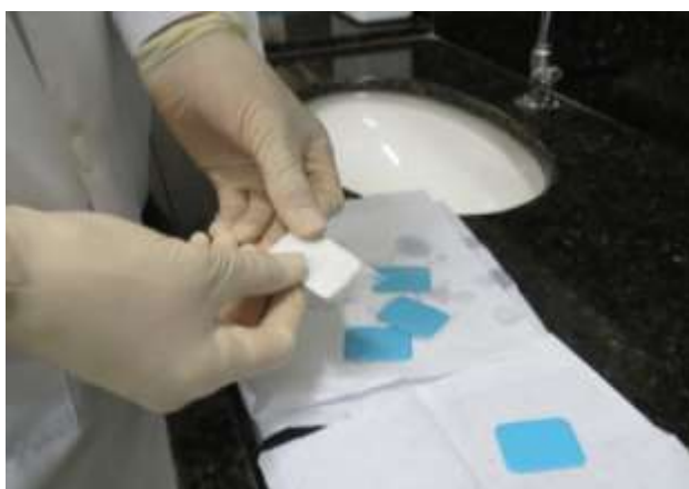
Figura 14. Operador com mãos enluvasadas deverá remover o plástico transparente sem contaminar a superfície do filme radiográfico
